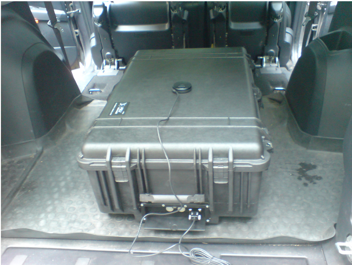
Рисунок 2. Размещение автомобильного гамма-спектрометра в задней части автомобиля Mitsubishi Outlander XL для проведения гамма-съёмки местности. На крышке контейнера лежит внешний датчик навигации Garmin GPS 18x 5Hz.
