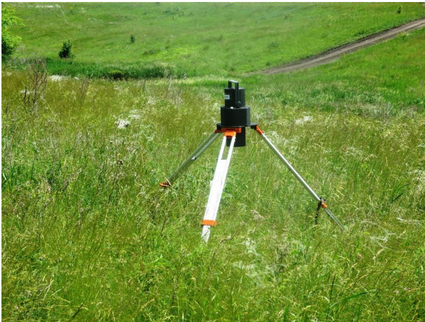
Рисунок 3. InSitu гамма-спектрометр ВVK-1. Измерения содержания техногенных радионуклидов в грунте.
